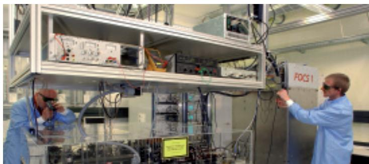
*Les différents éléments de l'étalon primaire de fréquence FOCS1 - la table optique (premier plan), le système à vide (à droite) et l'électronique de contrôle (arrière plan) - sont installés dans un laboratoire à l'office fédéral de métrologie et d'accréditation qui est protégé des influences de l'environnement comme les vibrations et les variations de température ou de l'humidité.*
