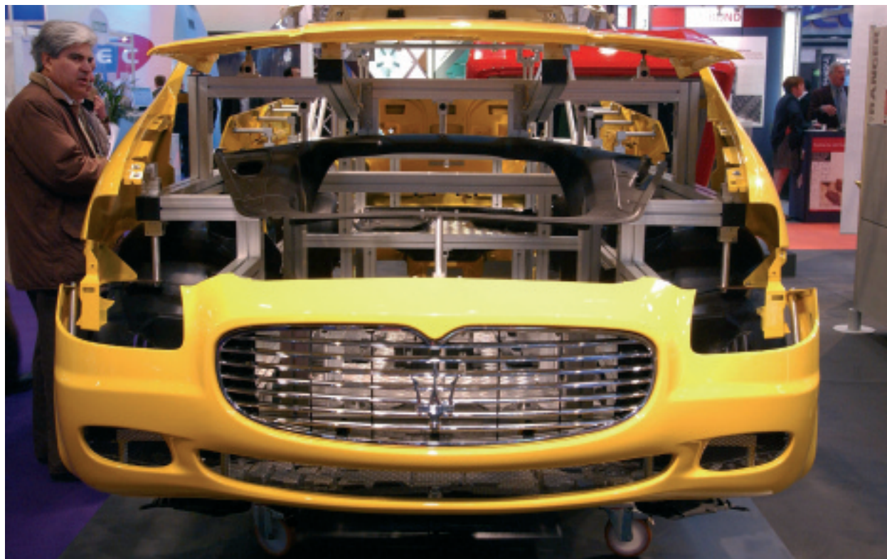
Structure de voiture réalisée en composites et présentée lors du JEC Show 2004 par Ranger Group
