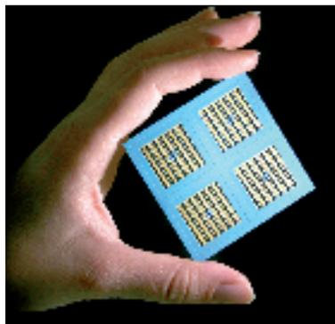
*Des plaquettes de silicium permettent de réaliser des piles à combustible miniatures.*
