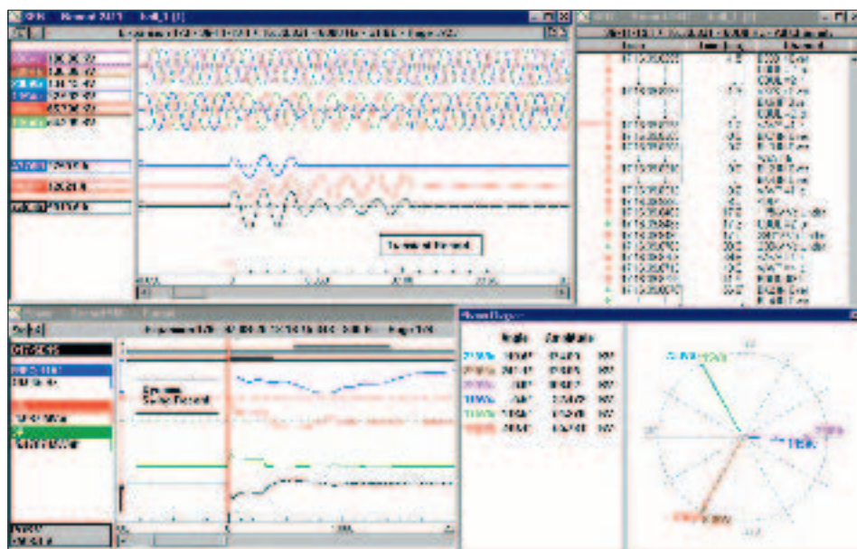
Cette figure illustre quelques visualisations d'un même incident qui diffèrent selon que l'utilisateur est intéressé par le transitoire rapide, par le profil de qualité de l'électricité, par les phaseurs ou par la séquence des événements.
