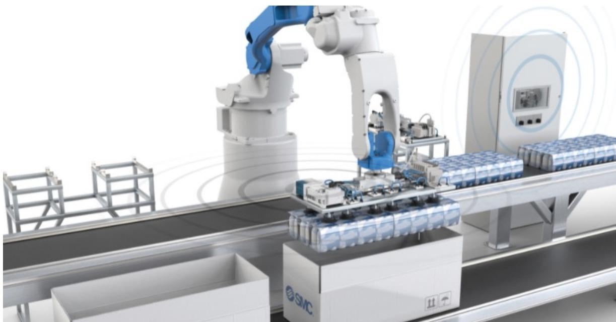
Robot dans une application d'emballage avec communication sans fil pour assurer une communication série fiable et une flexibilité lors du changement de l'outil en bout de bras (EOAT)
