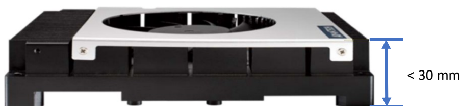
Figure 6. Système de conduction thermique dynamique (vue latérale)
