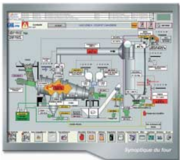
Vue synoptique du fonctionnement du four sur un écran d'ordinateur, avec les différents paramètres à régler pour en optimiser le fonctionnement.
