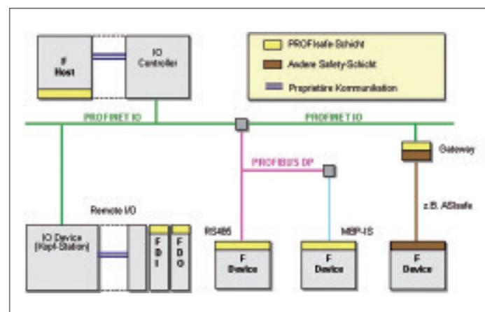
Le système Profisafe englobe l'ensemble des voies de communication, des capteurs aux commandes affectées à la sécurité.
