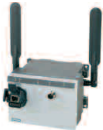
Point d'accès Scalance W788-2 Pro de Siemens, fonctionnant sur les bande 2,5 et 5 GHz, 14 canaux.
