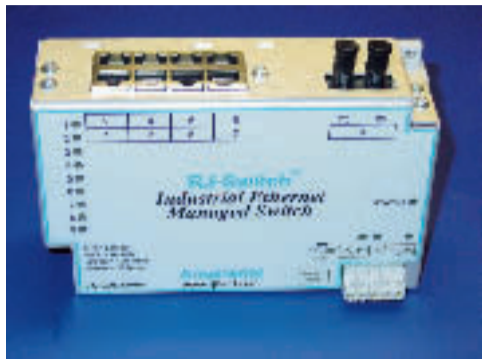
Commutateur Ethernet Amphenol, RJS 5RS1, à temps de reconfiguration de 30 ms
