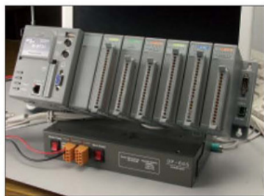
ICP DAS (6TA) : plate-forme d'entrées/sorties intelligente sous Win CE.net.
