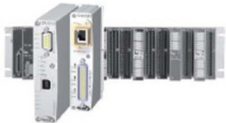
Leroy LT200 (Azur) : calculateurs temps réel linux RTAI pour E/S déportées.
